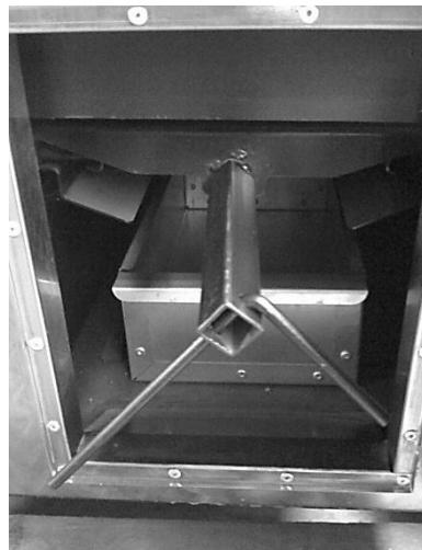
mehanizem za nastavitev režima kurjenja pri štedilniku C-20 s ključem za dvigovanje (24)
