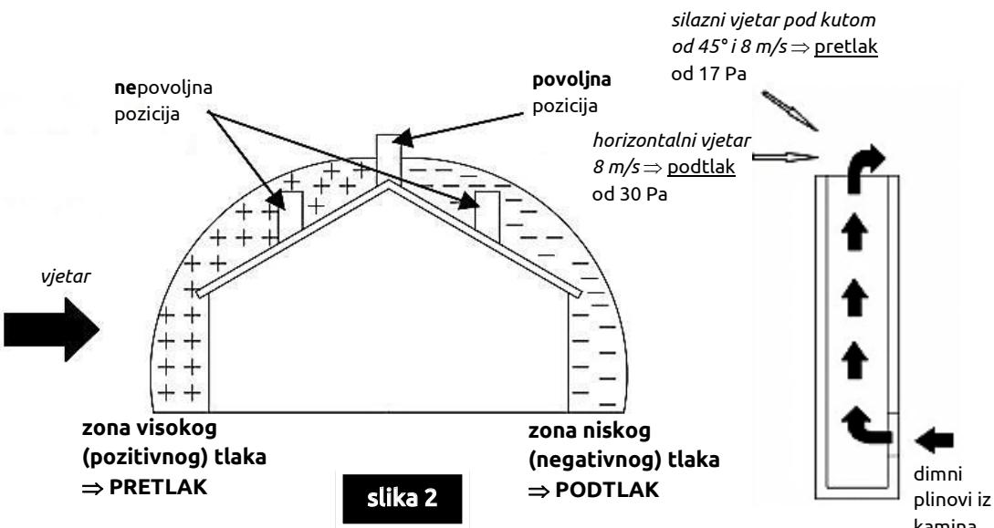
Vjetar utječe na funkciju dimnjaka i indirektno stvarajući zone visokog (pretlak) i niskog (podtlak) tlaka i izvan i unutar stambenog prostora (*slika 3*).
