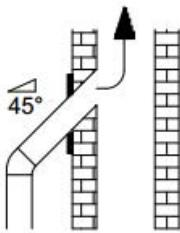
pogrešan dovod zraka kroz rupe nastale prilikom nepravilnog priključka cijevi na dimnjak
