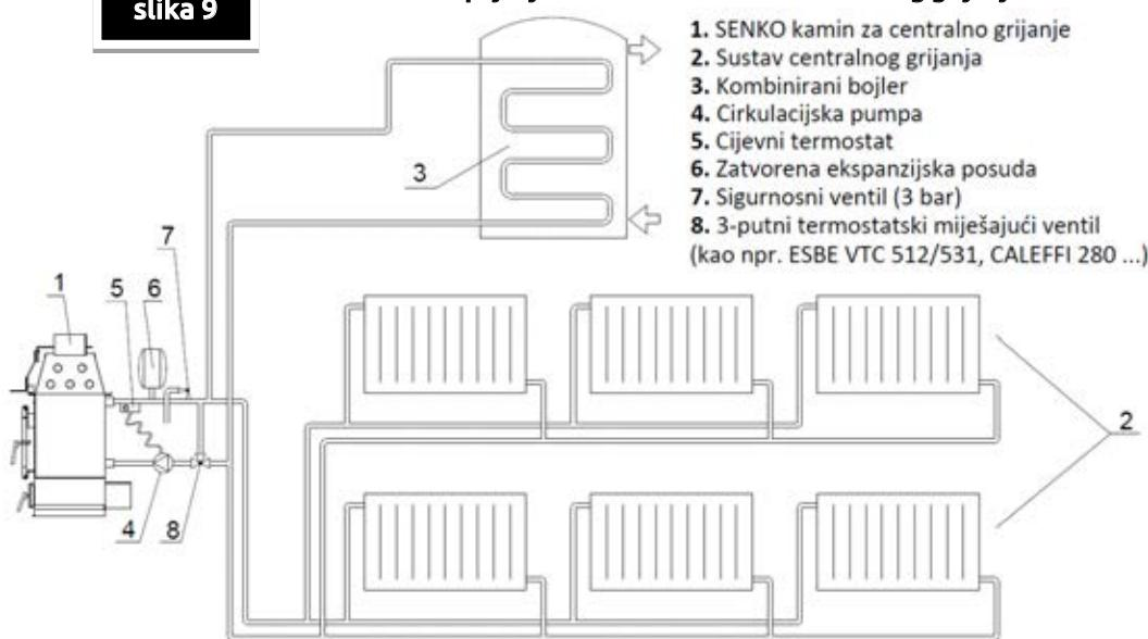
Također je potrebno ugraditi odzračni ventil. Kod punjenja kotla i radijatorskog sustava potrebno je otvoriti miješajući ventil ukoliko je isti ugrađen, dobro odzračiti kotao i sustav grijanja.
