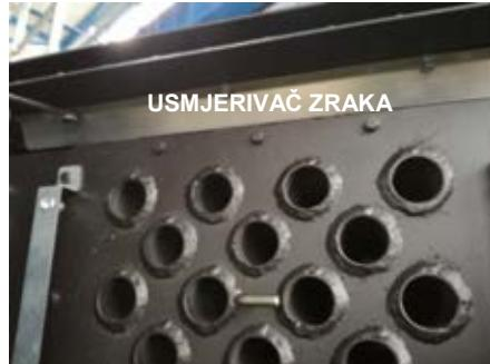
4. Maknite crnu ploči i, ako je potrebno, izvadite okrugli poklopac pritiskom na najslabiji spoj (na crnoj ploči i na limu ispod). Montirajte produžetak cijevi ("1" na *slici 18*) na lim pomoću vijaka ("3" na *slici 18*)
