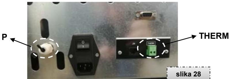
Peć možete spojiti i na **sobni termostat**. Žice termostata spojite na priključak "THERM" na stražnjoj strani peći. U ovom slučaju sonda (**P**) na stražnjoj strani peći više nema svoju funkciju. Ovlašteni serviser mora aktivirati termostat u tehničkom izborniku.
