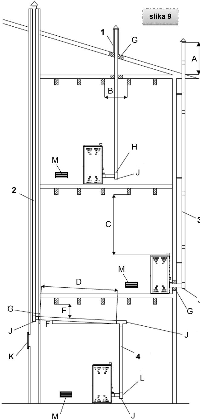
**1 – instalacija dimnjaka promjera Ø100mm sa razmakom oko cijevi (B):**
